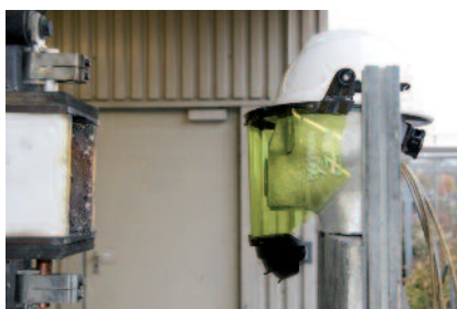
MSA Elektrikerset vor "Prüfung mit Open Box", 7 kA
